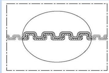
Abriebfester, ölbeständiger und mit Polyurethan ummantelter Metall-Schutzschlauch; sehr robust und flüssigkeitsdicht; eingehaktes Metallprofil
